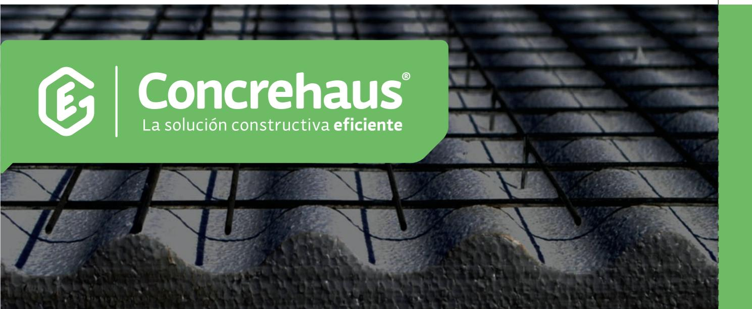
Sus paneles monolíticos estructurales están formados por un núcleo de EPS Isopor® o Neotech® y mallas de acero de alta resistencia que, junto con el concreto proyectado, se transforman en una estructura continua de gran capacidad portante. Esta innovadora tecnología permite construir integralmente viviendas o cerramientos de edificios en altura con gran facilidad y elevando la productividad de los recursos de la obra.
